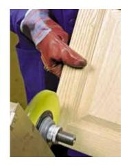
Круги Scotch-Brite<sup>TM</sup> Bristle представляют собой тонкие диски из полимерного материала с гибкими щетинками по окружности. Зерна абразивного материала  $3M^{TM}$  Cubitron<sup>TM</sup> равномерно распределены по всему объему полимера.
